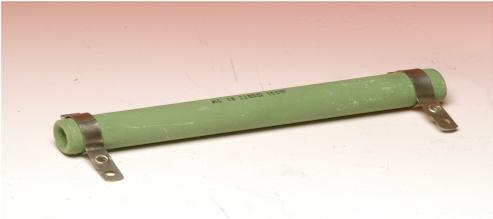
CARATTERISTICHE GENERALI: I resistori della serie T1 e T8 sono realizzati nelle forme e nelle dimensioni unificate presenti sul mercato. Su un supporto in steatite è avvolto l'elemento resistivo costituito da filo in lega resistiva rivestito da strato di smalto vetroso fissato ad alta temperatura per una protezione nel tempo (versione T1), oppure da un rivestimento di cemento ad alta conducibilità termica (versione T8).
