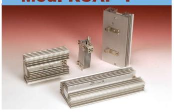
Le resistenze anticondensa vengono utilizzate per ovviare alla creazione della condensa all'interno dei quadri. Sono realizzate con un dissipatore in alluminio anodizzato nel quale viene alloggiato un termistore PTC che consente di alimentare la resistenza con tensione variabile da 110Vca/cd a 260Vca/cc ottenendo una temperatura superficiale costante di circa 70/80°C.
