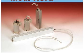
Le resistenze anticondensa vengono utilizzate per ovviare alla creazione della condensa all'interno dei quadri. Sono realizzate con un dissipatore in alluminio anodizzato nel quale viene alloggiato un resistore termostatato, il quale può essere alimentato con tensione Variabile da 12Vca a 380Vca a seconda della necessità del cliente ottenendo una temperatura superficiale costante di circa 70°C.
